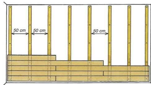
Posez la 1<sup>ère</sup> lame en vérifiant le niveau de la verticale et de l'horizontale. Laissez un espace en partie basse de 10 mm minimum pour laisser un passage d'air qui sera très vite recouvert par une plinthe.
